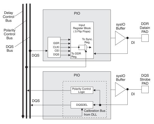
Figure 2-27. DLL Calibration Bus and DQS/DQS Transition Distribution
