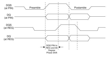
Figure 10-3. DQ-DQS During WRITE
