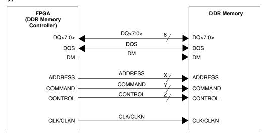
Figure 10-2. DQ-DQS During READ
